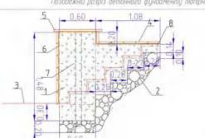
Поздовжній розріз бетонного фундаменту підріної стінки 2-3
